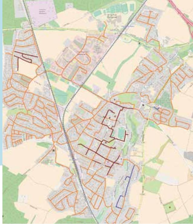
Wie zu Beginn des Geothermie-Ausbaus versprochen, durchzieht das Fernwärmenetz bereits den größten Teil der Gemeinde. In dunkelrot dargestellt die ursprünglichen Bestandsnetze der Hackschnitzel-Heizwerke Pestalozzistraße und Grünwalder Weg. In blauer Farbe sind die aktuellen Bauabschnitte dargestellt.
